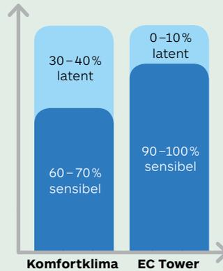
$$\begin{aligned} \text{Totale Kühlleistung} &= \\ &= \text{Latente Kühlleistung* (Entfeuchtung)} \\ &+ \\ &+ \text{Sensible Kühlleistung* (Absenkung der Raumtemperatur)} \end{aligned}$$
